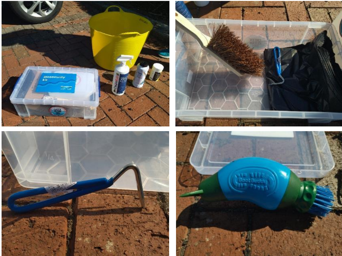
Figuur 4. Voorbeeld van een Bioveiligheid kit (Yorkshire Water, UK). Linksonder: Hoevenkrabber om het loopoppervlak van schoeisel te ontdoen van debris. Rechtsonder: Boot buddy®, een handige tool voor het schoonmaken van laarzen en schoenen. Fotos: NSSIAS
